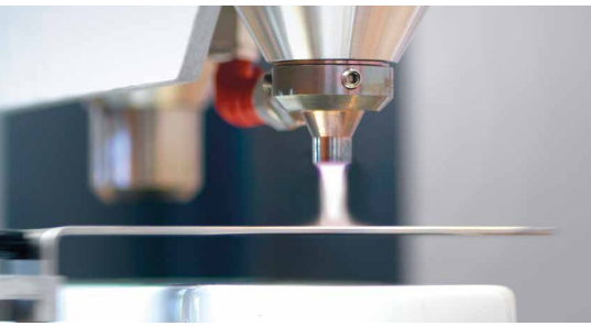
Vorbereitung für den PST-Hybrid-Spritzguss: Funktionale Beschichtung mit PlasmaPlus®
