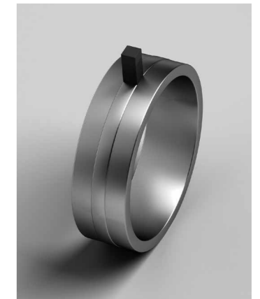
Abb. 6: Prinzipskizze der Block-auf-Ring-Verschleißmessung
