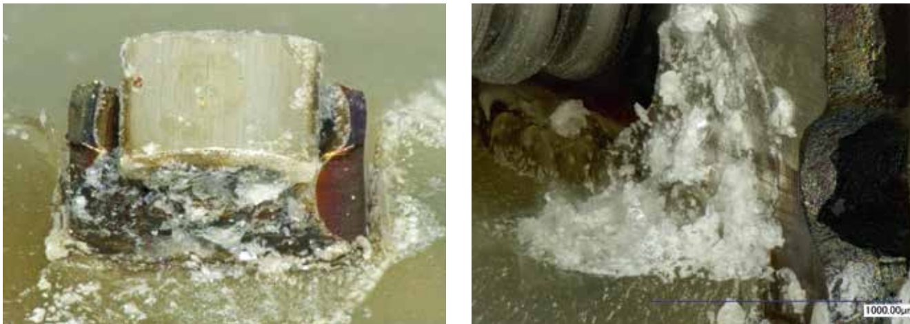
Bild 3. Ablagerungen von Metallseifen (links), Detailaufnahme der Ablagerungen (rechts)
