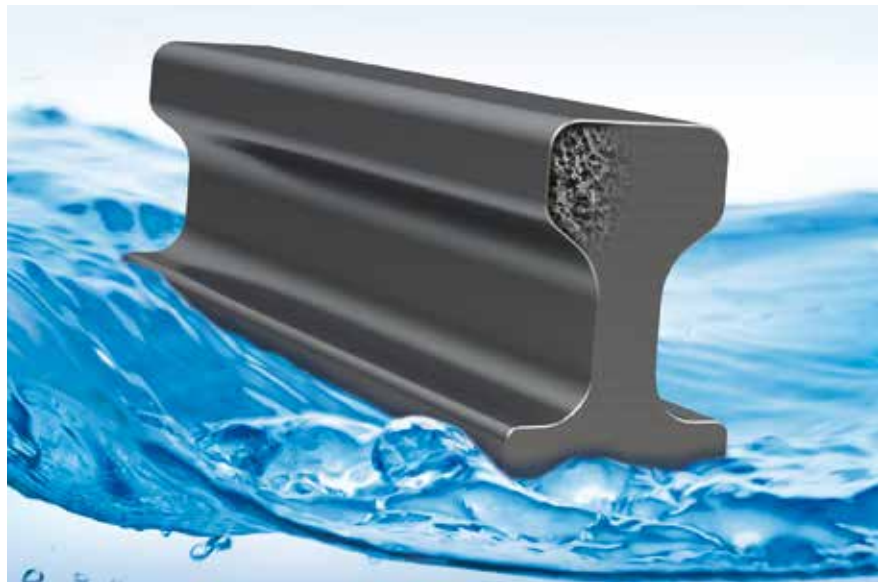
Bauteile aus einem neu entwickelten (Polyamid+Polypropylen)-Blend sind mit einer Dichte kleiner als Eins leichter als Wasser (Bilder: Akro-Plastic)
