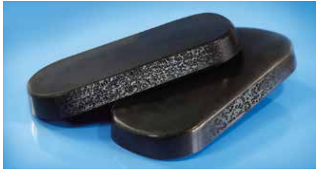
Bild 1. Effekt der Erhöhung der heterogenen Nukleierung (Bauteil oben: nukleiert, Bauteil unten: nicht nukleiert)
