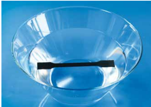
Bild 2. Der Zugstab aus dem (PA+PP)-Blend Akromid B3 ICF 20 1 L schwarz (5296) besitzt eine Dichte unterhalb der von Wasser
