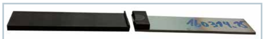
Bild 4. Kohäsiver Bruch eines im PlasmaPlus-Verfahren gefügten PA6GF30-Edelstahl-Prüfkörpers (© Plasmatreat)
