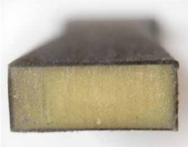
Bild 3. Zugstab aus Akromid C3 GF 30 5 XTC natur (4499) nach 1000 h bei 210 °C (© Akro-Plastic)
