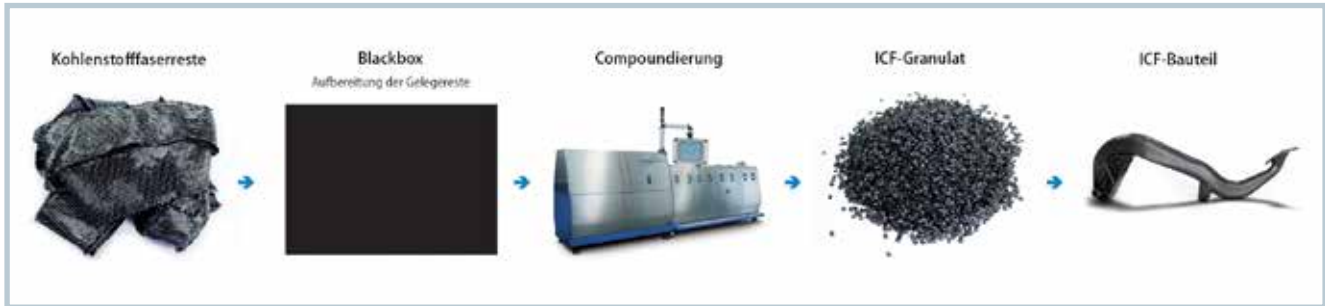
Bild 1. Produktionsprozess von Bauteilen aus mit Kohlenstofffasern gefüllten Compounds
