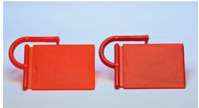
Bild 5. Eingefärbte Prüfplatten aus Polyamid 6 nach Belastung der Polymererschmelze bei 320 °C in einem Zeitraum von 4 min (links: PA6, rechts: mit neuartigem Träger)
