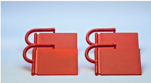
Bild 4. Mit Pigment des Grundkörpers Diketopyrrolopyrrol eingefärbte Prüfteile (links: auf Basis PA6, rechts: auf Basis eines neuartigen Trägers)
