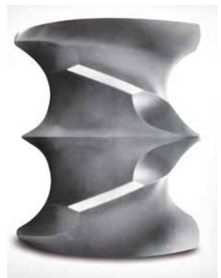
Bild 3. Mischelement einer knetblockfreien Schnecke zur Herstellung von biobasierten Masterbatches bei niedriger Temperatur
