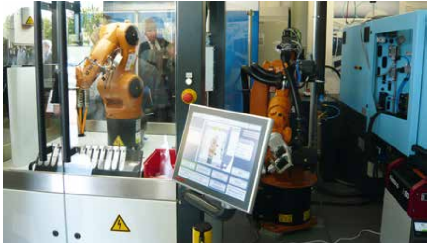
Bild 2. Die Technikumsanlage im Profil. Links werden die metallischen Probekörper vom Roboter aufgenommen, zunächst gereinigt, dann mit Plasma oberflächenbeschichtet. Danach übernimmt ein zweites Handlingsystem (Mitte), der Probekörper wird auf mehr als 220 °C erwärmt und ins Werkzeug eingelegt (rechts). Dort wird der mit Plasma vorbehandelte Abschnitt mit Polyamid angespritzt (© F. Gründel/Hanser)
