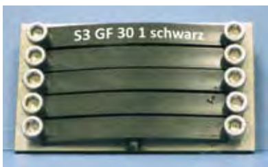
AKROMID ® S3 GF 30 1 nach der Auslagerung in ZnCl 2 -Lösung unter Biegebeanspruchung
