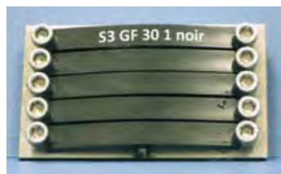
AKROMID® S3 GF 30 1 après vieillissement dans une solution de ZnCl 2 sous contrainte de flexion
